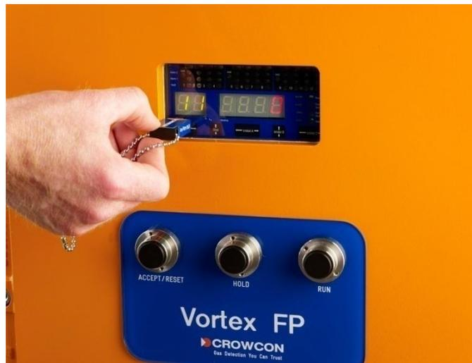
Le Vortex FP Compact comporte un module d'affichage qui permet d'afficher les signaux des détecteurs et de fournir un rapport de l'état actuel du système. Les fonctions d'affichage sont commandées par un outil d'étalonnage Crowmag qui doit être orienté (à l'horizontale ou à la verticale) comme indiqué par les flèches qui sont dans les champs des fonctions d'affichage.
