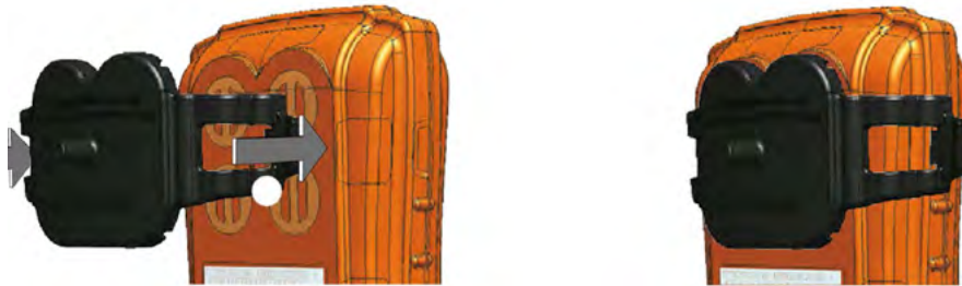
Figure 5: Installation de la plaque de calibrage / essai de fonctionnement
